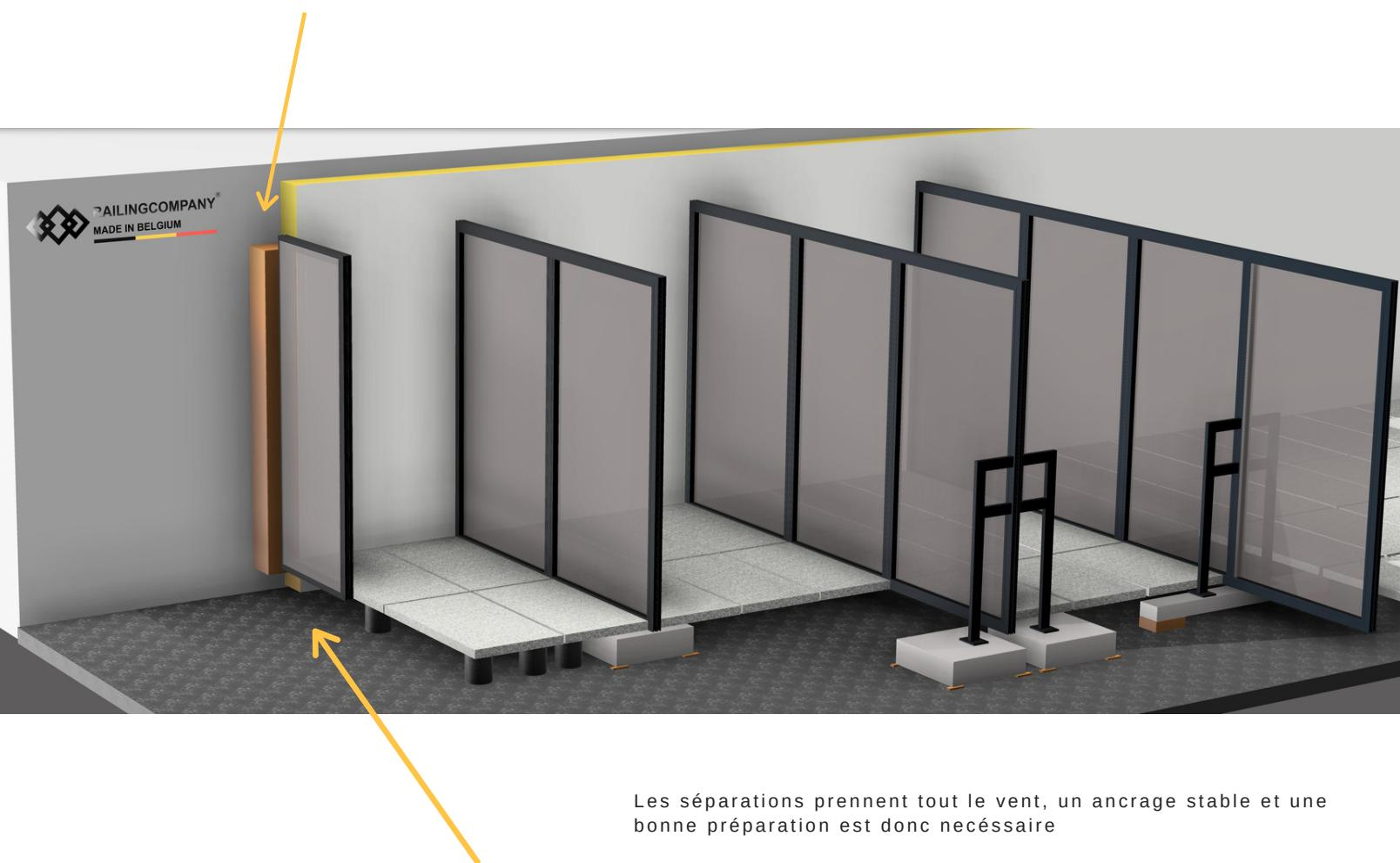
Les séparations prennent tout le vent, un ancrage stable et une bonne préparation est donc nécessaire
